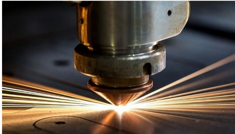
Técnica que se caracteriza por su fuente de energía que contiene un laser que concentra la luz para poder realizar el corte deseado.
